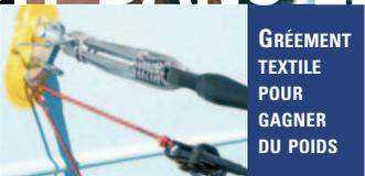
Le poids dans les hauts est un point particulièrement sensible à bord d'un multicoque car il favorise le tangage. Plus encore qu'un mât carbone par rapport à un profil en alu, le gréement textile, en lieu et place de l'inox, permet un réel gain de poids et pour un investissement bien moindre ! Le ridoir inox est lui aussi remplacé par un brélage en Vectran.
