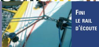
Le rail d'écoute de solent est remplacé par un barber; l'écoute passe au travers d'un anneau en titane, le point d'écoute se règle donc selon l'allure soit par l'écarteur (cordage en Vectran, gris), soit par le rentreur (palan bleu). On notera la manille de fixation de la poulie, remplacée elle aussi par un brélage en Vectran.
