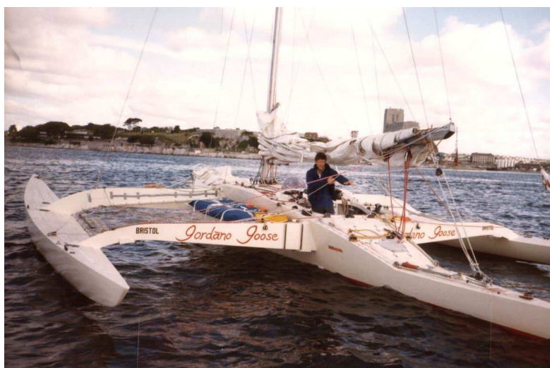
Flotteurs volumineux, petites crosses, coque centrale ultrafine et construction "béton" : un précurseur vient de naître!
