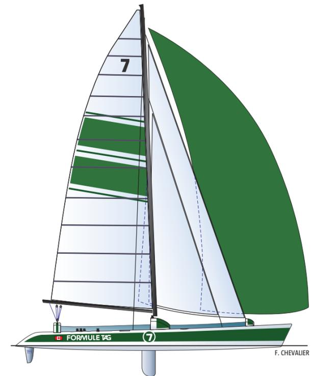
Architecte: Nigel Irens (GBR). Constructeur: Canadair (CAN). Longueur: 24,38 m (1983); 24,80 m (1985); 25,90 m (1993); 28,00 m (1994); 30,50 m (2000). Largeur: 12,65 m. Déplacement: 8,85 t (1983); 10,5 t (1993); 9,75 t (1994); 14,5 t (2000); 25 t (2016). Tirant d'eau: 3,12 m. Voilure au près: 280 m<sup>2</sup> (1983); 310 m<sup>2</sup> (1985); 320 m<sup>2</sup> (1993); 340 m<sup>2</sup> (2000); 500 m<sup>2</sup> (2016).
